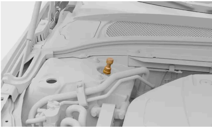
De afstelknoppen van de vering van de voorwielen zitten onder de motorkap.
