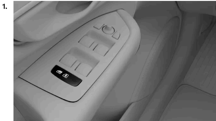
Locatie van de knop voor het kinderslot op het portierpaneel
