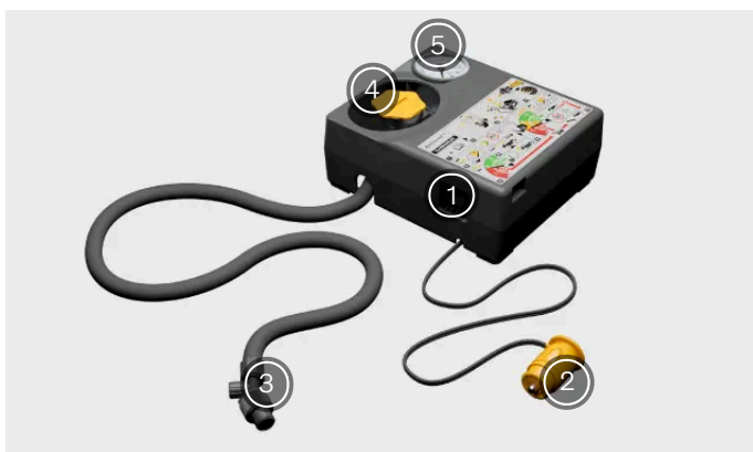
Overzicht van de compressor van de noodreparatieset
