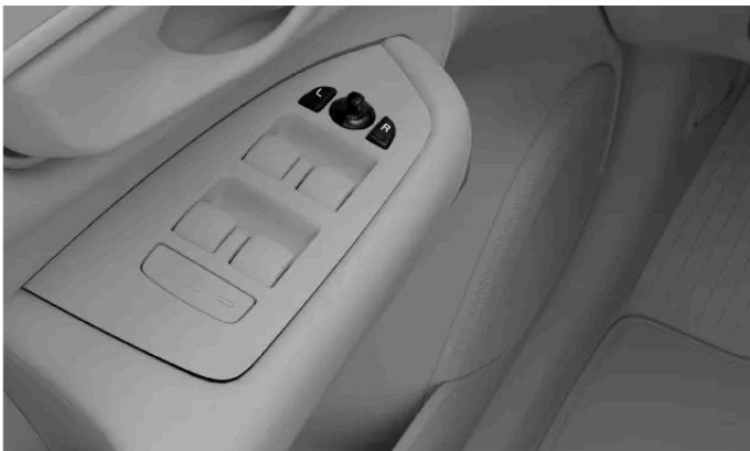
Knoppen voor het verstellen van de buitenspiegels
