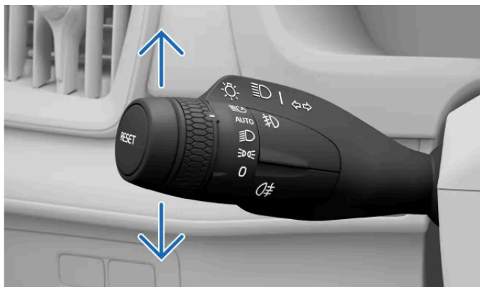
De richtingaanwijzers op de linkerhendel
