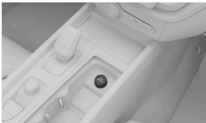
De 12V-aansluiting in de tunnelconsole
