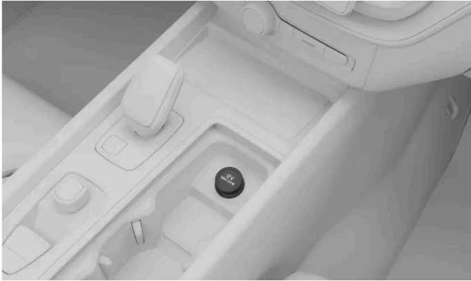
De 12V-aansluiting in de tunnelconsole
