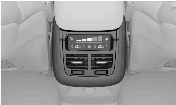
Bedieningselementen voor het klimaatsysteem op de tunnelconsole
