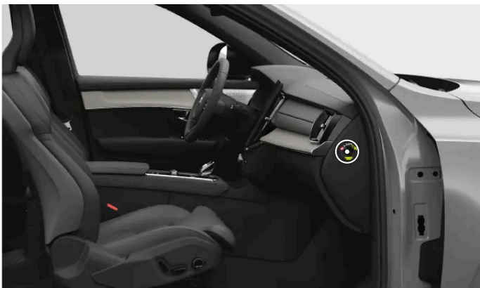
Locatie van de schakelaar voor de passagiersairbag
