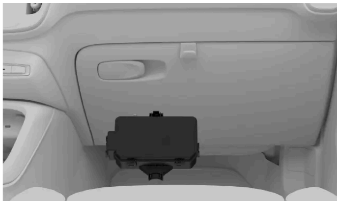
Localização da caixa de fusíveis
