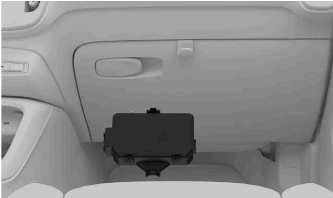
Localização da caixa de fusíveis
