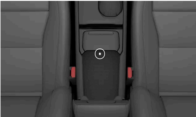
Localização do leitor de reserva dentro do compartimento de armazenamento do console de túnel
