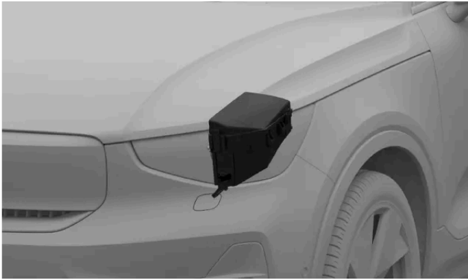
Localização da caixa de fusíveis
