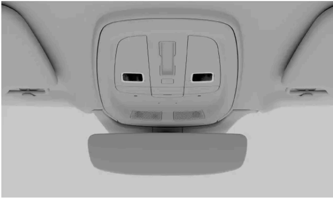
As luzes de leitura dianteiras no console suspenso
