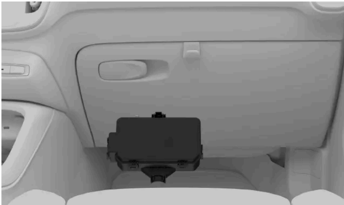
Localização da caixa de fusíveis
