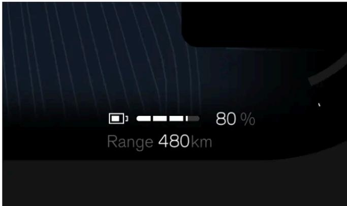
Sua autonomia está relacionada principalmente ao nível da bateria do veículo e às suas práticas de condução, mas as condições externas também podem ser um fator. O nível da bateria e a autonomia esperada são exibidos no visor do motorista. A autonomia esperada é calculada com base em seu padrão de condução, tanto atual quanto histórico.
