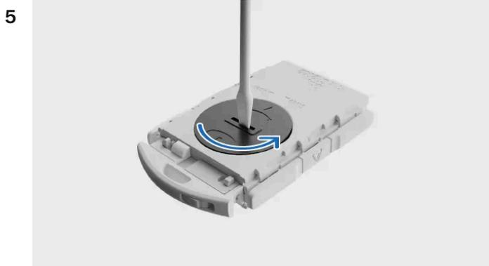
Usando uma ferramenta adequada, como uma chave de fenda ou uma moeda, gire a tampa da bateria no sentido anti-horário para liberá-la.
