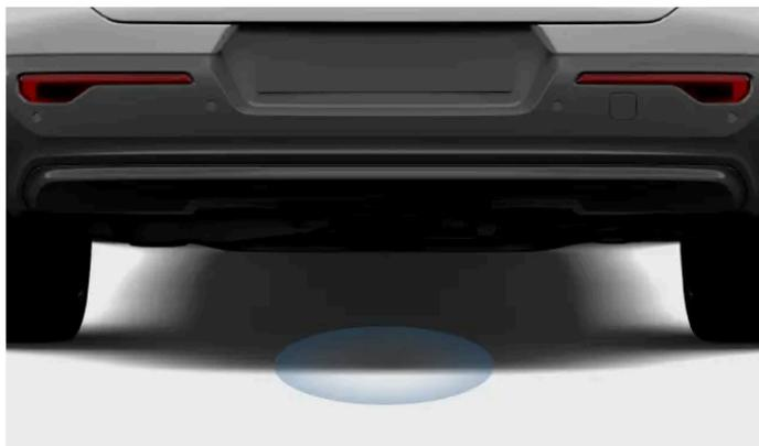
O sensor detecta movimentos sob o para-choque traseiro. Qualquer movimento detectado desbloqueia o porta-malas.
