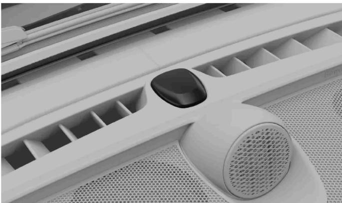
O indicador de alarme é uma luz localizada no centro do painel, bem em frente ao para-brisa. O indicador confirma quando o alarme é ativado com uma luz vermelha piscante.
