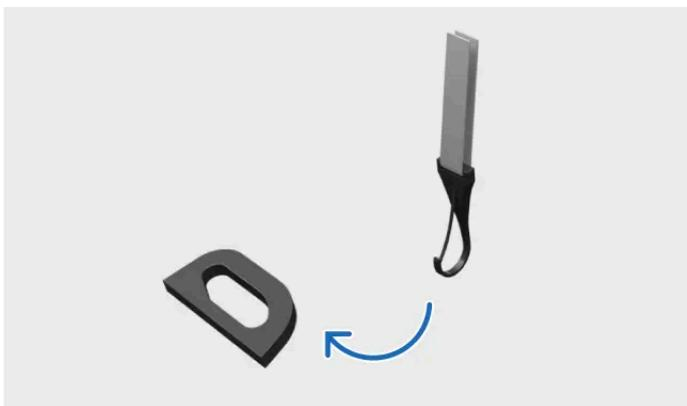
Fixação do cabo no ponto de ancoragem do cabo inferior
