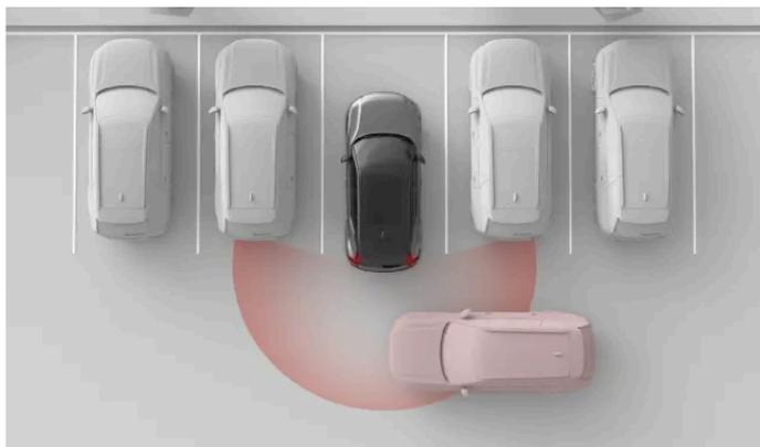
Seu veículo pode detectar um veículo cruzando atrás de você, por exemplo, ao dar ré para sair de uma vaga de estacionamento. Isso permite que ele o avise para que você possa reduzir a velocidade ou frear.
