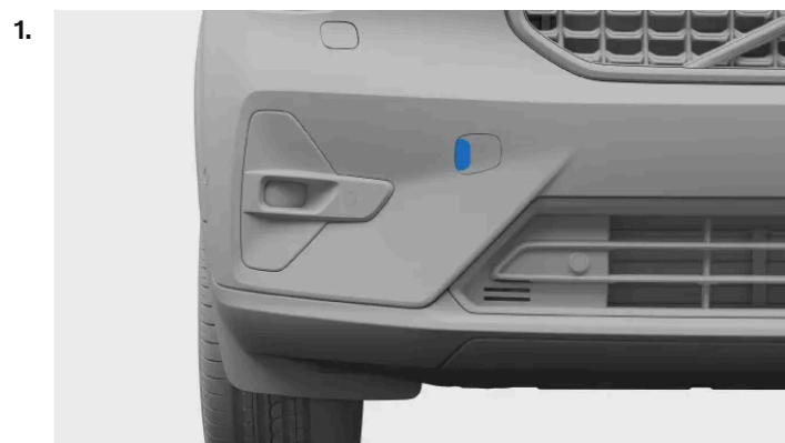
Tampa de fixação do olhal de reboque dianteiro
