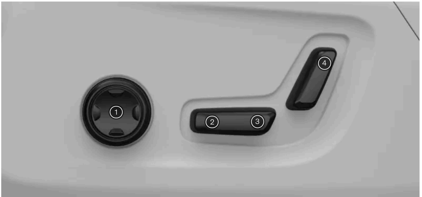
Controles na lateral do assento
