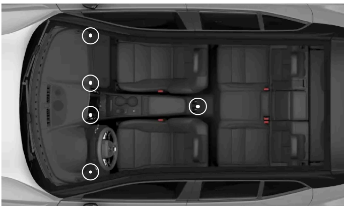
As posições das ventilações ajustáveis
