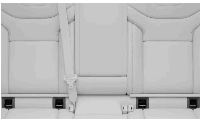
Localização dos pontos de ancoragem ISOFIX dos assentos traseiros
