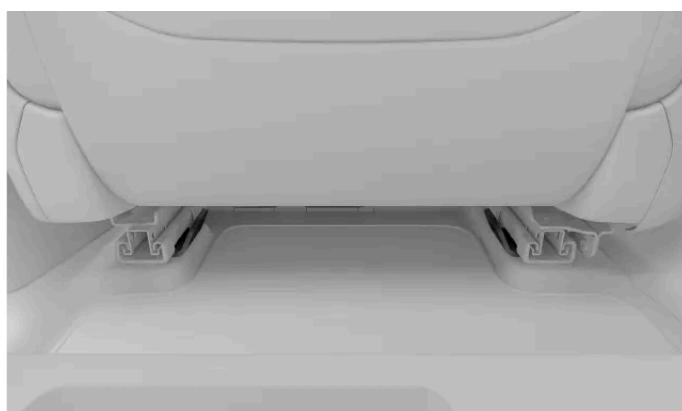
Os pontos de ancoragem inferiores dos assentos externos podem ser encontrados na parte de trás dos trilhos do assoalho dos assentos na frente.
