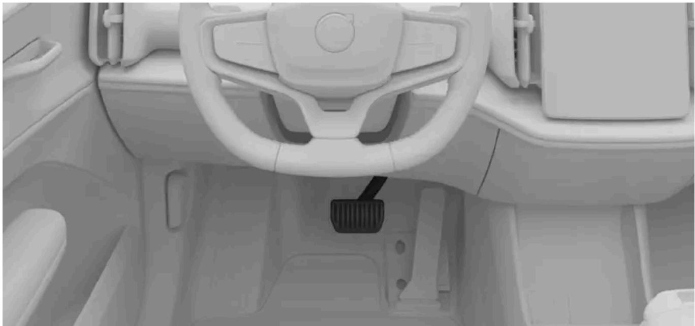
O freio de pé acopla tanto a frenagem regenerativa quanto os freios de fricção, dependendo de como você pressiona o pedal. A frenagem leve ativa a frenagem regenerativa, ao passo que a frenagem mais intensa acopla os freios de fricção.
