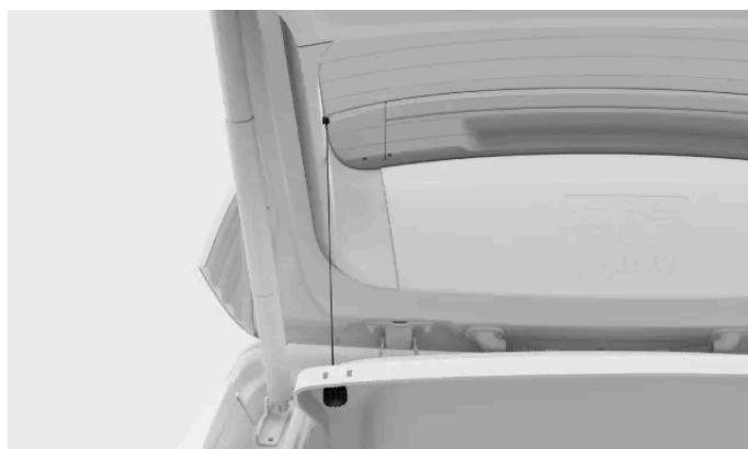
**1** Desconecte cada cabo dos pontos de fixação da tampa do porta-malas.
