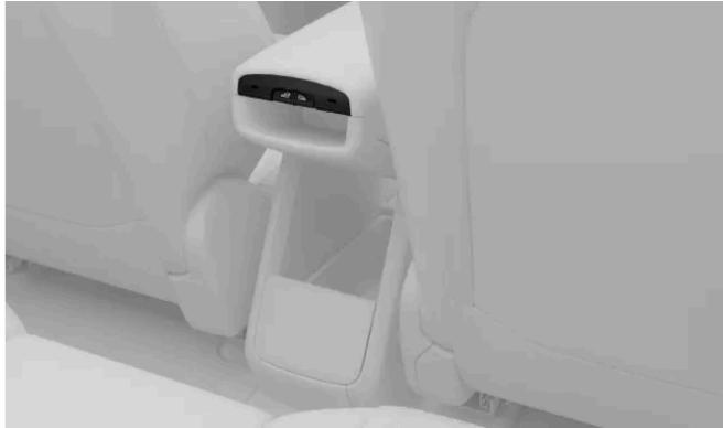
Nos bancos traseiros, você pode operar os vidros traseiros usando os interruptores na extremidade traseira do apoio do braço central.
