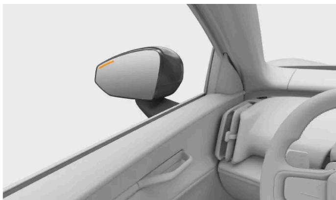
Quando um veículo é detectado em seu ponto cego ou se aproximando dele, uma luz é exibida no espelho retrovisor lateral.
