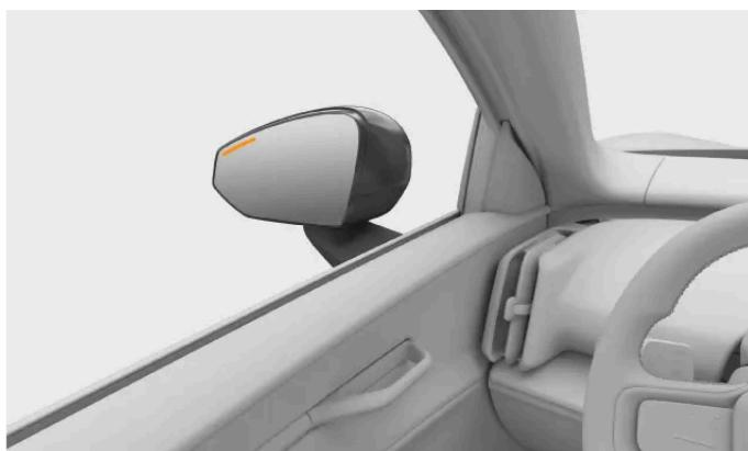
Quando o veículo detecta que o tráfego está prestes a passar próximo às laterais do veículo, uma luz é exibida no espelho retrovisor lateral juntamente com uma notificação no visor. Se você começar a abrir a porta do lado do tráfego detectado, o alerta se intensificará. Um alerta sonoro pode ocorrer junto com os alertas visuais, dependendo da urgência do aviso.
