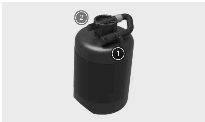
Visão geral do frasco de fluido de vedação do jogo de reparo de punção temporário
