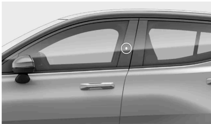
Local de leitura da chave no pilar da porta
