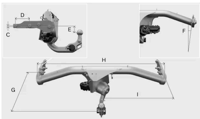
Medidas, pontos de fixação em milímetros (polegadas)
