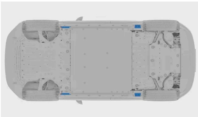
Existem dois pontos de levantamento em cada lado do veículo.
