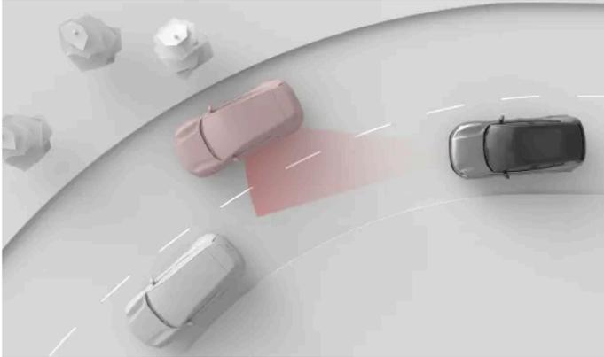
Em uma curva, o veículo adiante pode sair da zona de detecção. Os veículos na faixa adjacente também podem entrar na zona, afetando a percepção do seu veículo quanto à distância do tráfego adiante.
