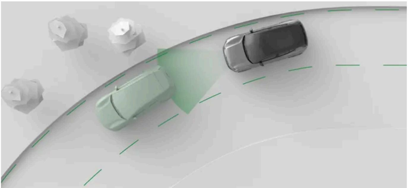
O Pilot Assist orienta ativamente sua condução de várias maneiras. Ao dirigir com o Pilot Assist, você seleciona a velocidade alvo. Em seguida, o veículo gerencia a aceleração e a frenagem para atingir esse alvo e, ao mesmo tempo, se adapta ao tráfego ao redor.
