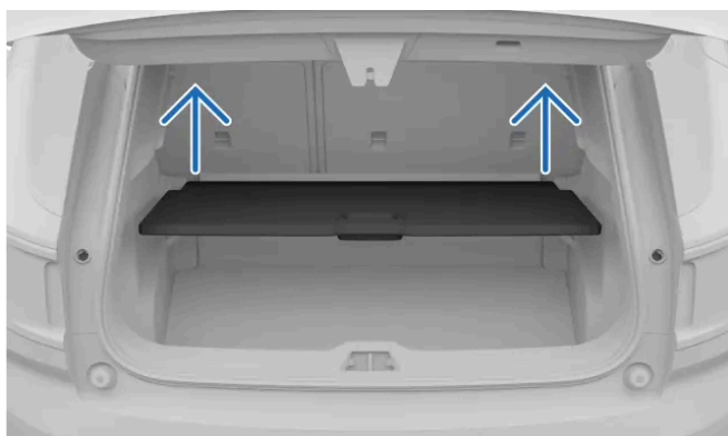
Guia ilustrativo para a remoção da tampa do compartimento de carga.
