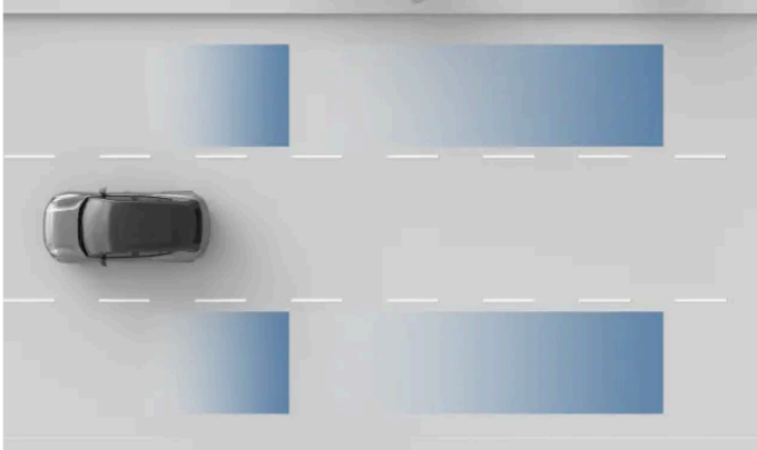
Áreas de detecção de radar
