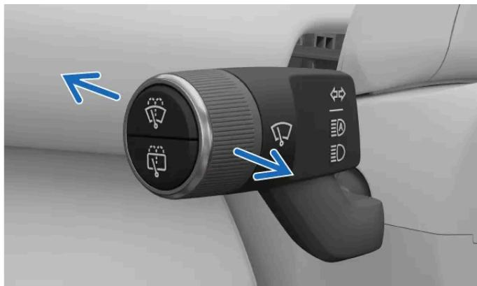
Você pode mover a haste do lado esquerdo para frente ou para trás para alternar entre as diferentes opções de farol alto. A alavanca sempre retorna à posição neutra.
