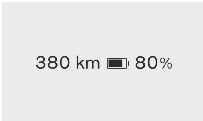
O medidor da bateria é sempre mostrado na área de informações do motorista. A cor do ícone da bateria muda conforme o nível restante de carga da bateria.
