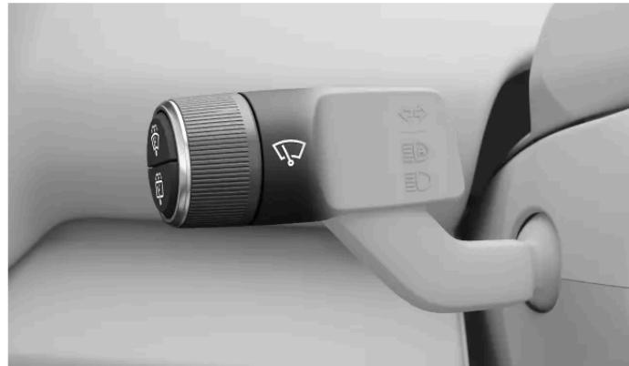
Você pode controlar os limpadores e lavadores usando a roda de rolagem e os botões na haste esquerda do volante de direção.
