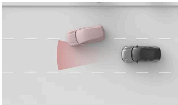
A zona de detecção do radar dianteiro tem uma largura limitada. Se você for ultrapassado por outro veículo, a detecção pode ocorrer relativamente tarde, causando uma resposta repentina do seu veículo.
