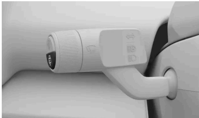
Você controla o limpador de para-brisas traseiro usando o botão inferior na haste do volante do lado esquerdo.
