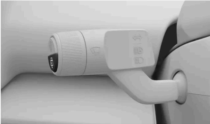
Você controla o limpador de para-brisas traseiro usando o botão inferior na haste do volante do lado esquerdo.
