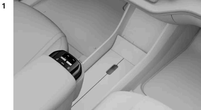
Dos bancos dianteiros, você pode controlar todos os vidros elétricos. Pressione o botão com o texto REAR para alternar entre a operação dos vidros dianteiros ou traseiros. O botão fica âmbar para indicar que os vidros traseiros estão selecionados. Os controles voltarão para os vidros dianteiros se você pressionar o botão novamente ou após alguns segundos de inatividade.
