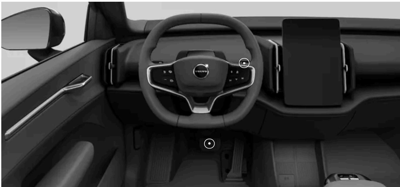
Os principais pontos de interação para dar partida no veículo são o pedal do freio e a alavanca de marcha.
