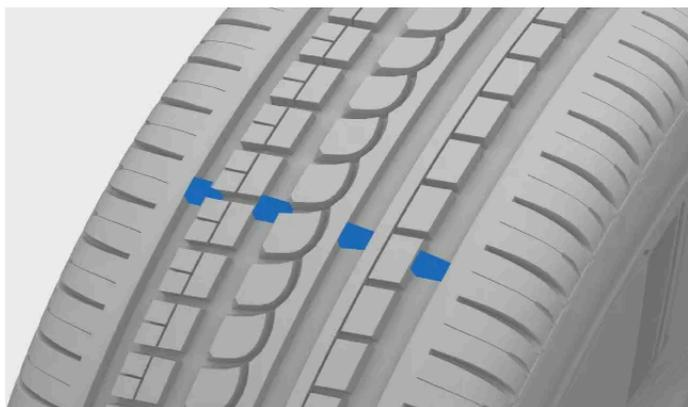
Os sulcos estreitos que percorrem longitudinalmente o padrão da banda de rodagem do pneu são indicadores de desgaste da banda de rodagem. Na lateral do pneu encontramos as letras TWI [1].
