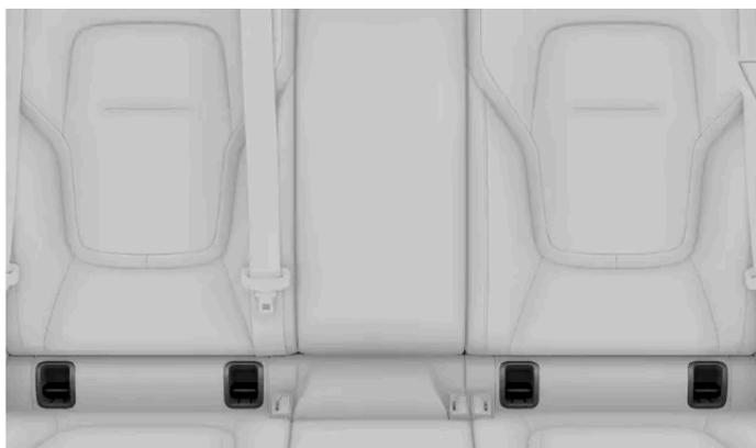
Os pontos de ancoragem ISOFIX para os assentos traseiros estão localizados atrás de uma aba na parte inferior do encosto dos assentos traseiros externos. A aba precisa ser desdobrada para acessar os pontos de ancoragem atrás
