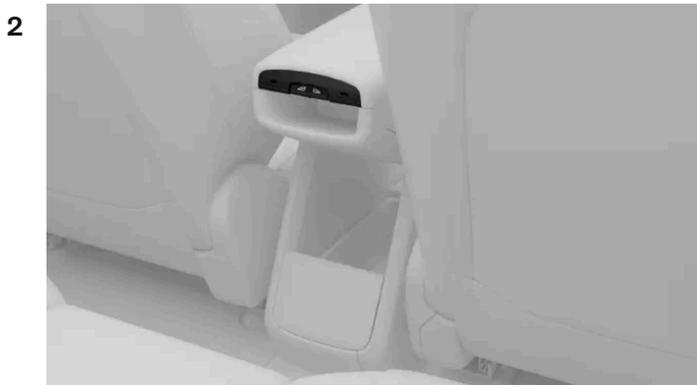
Nos bancos traseiros, você pode operar os vidros traseiros usando os interruptores na extremidade traseira do apoio do braço central.
