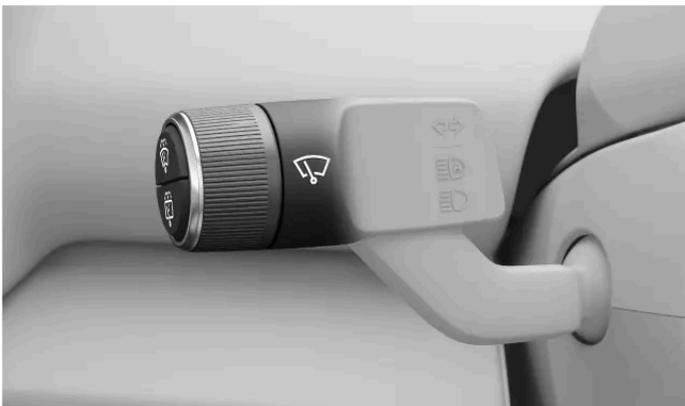
Você pode controlar os limpadores e lavadores usando a roda de rolagem e os botões na haste esquerda do volante de direção.
