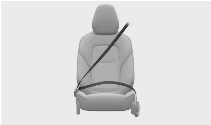
Cinto de segurança corretamente afivelado e ajustado.
