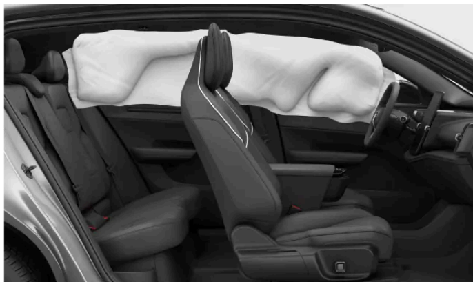
Cortina inflável colocada em um dos lados do veículo.
