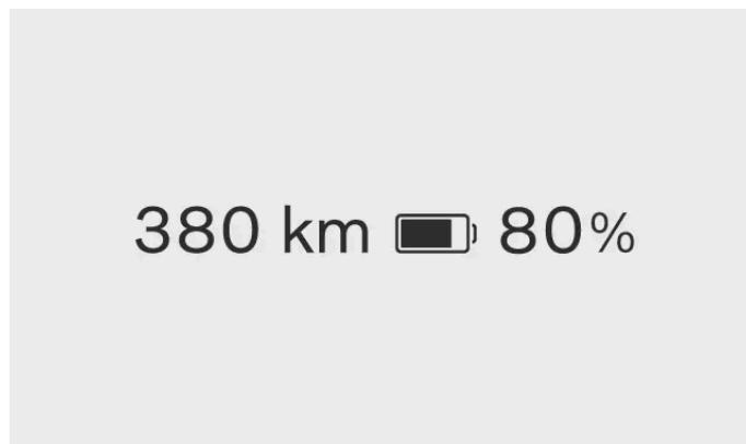
O medidor da bateria é sempre mostrado na área de informações do motorista. A cor do símbolo da bateria muda conforme o nível restante de carga na bateria.
