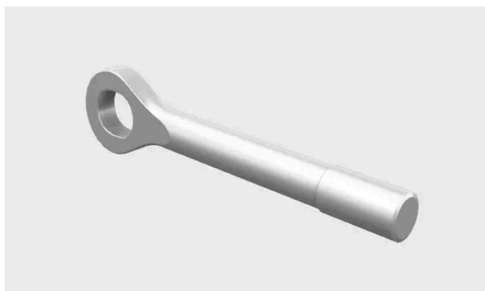
O olhal de reboque pode ser preso no para-choque do veículo para possibilitar o reboque. Ele também pode ser usado para prender objetos carregados no teto que sejam maiores do que o teto.
