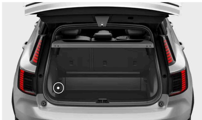
**3** Remova a tampa puxando-a com uma chave de fenda ou ferramenta similar.
