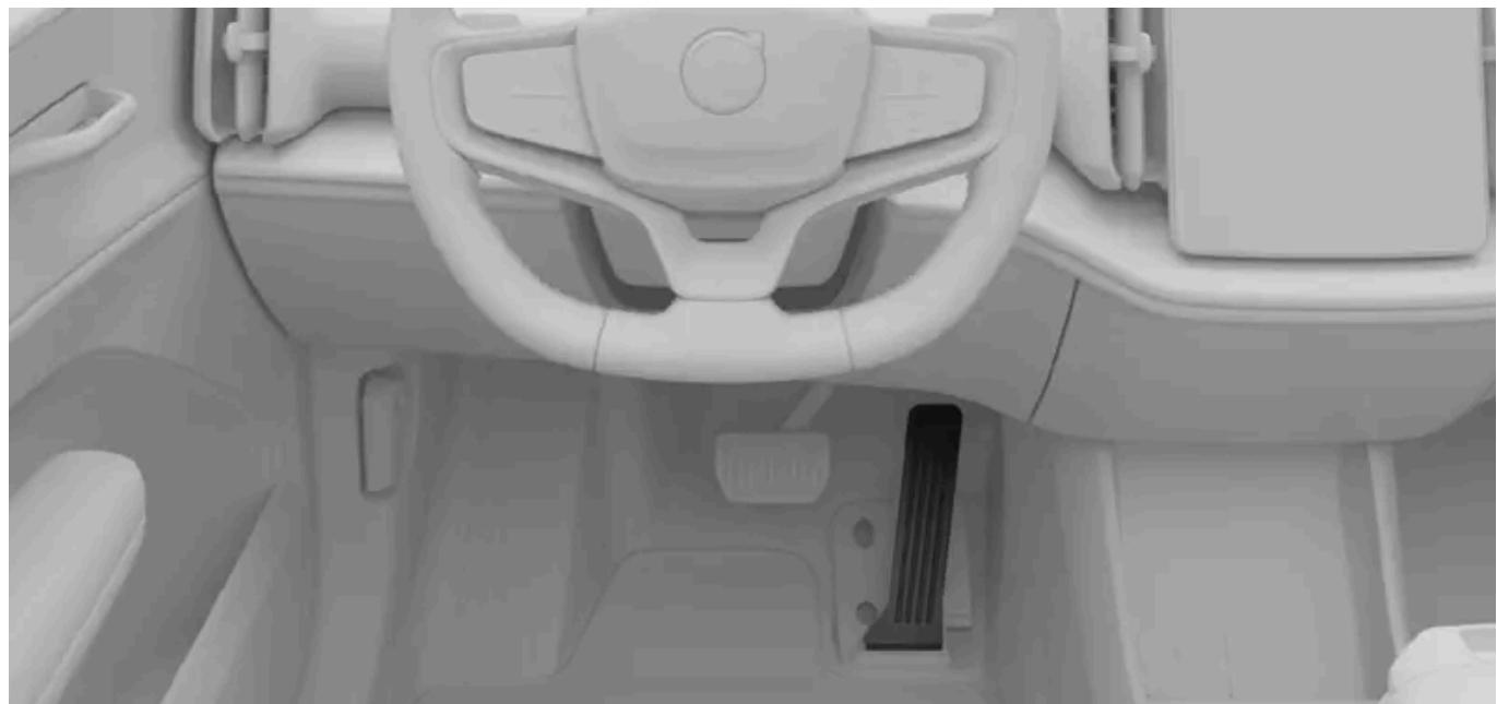
O comportamento de frenagem muda por meio do uso do pedal do acelerador. Quando você pressiona o acelerador, o veículo acelera normalmente, mas soltar o pedal aciona a frenagem. Quanto mais você soltar o pedal, maior será a ação de frenagem.
