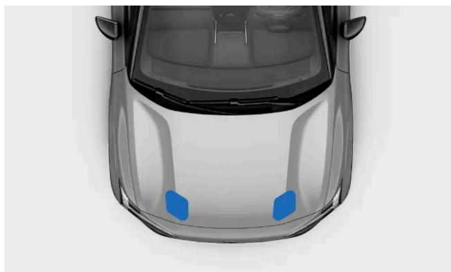
Pressione para baixo com as duas mãos a borda dianteira da tampa do capô. Certifique-se de que o capô encaixe nas travas ao mesmo tempo. Mantenha a borda dianteira plana ao fechar.
