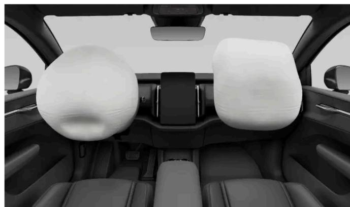
O airbag do lado do motorista é acondicionado dentro do volante de direção.
