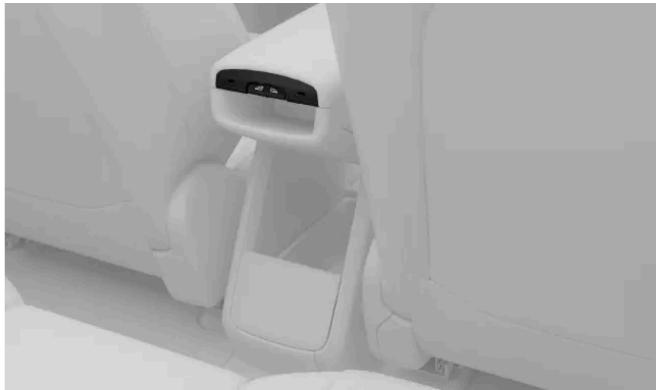
Nos bancos traseiros, você pode operar os vidros traseiros usando os interruptores na extremidade traseira do apoio do braço central.
