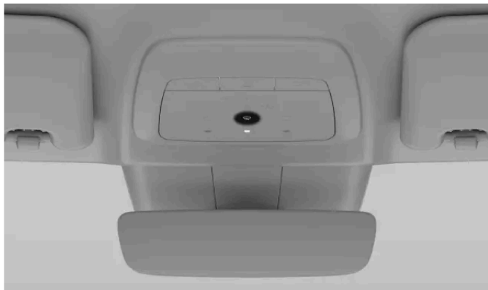
Botão do degelo no console suspenso
