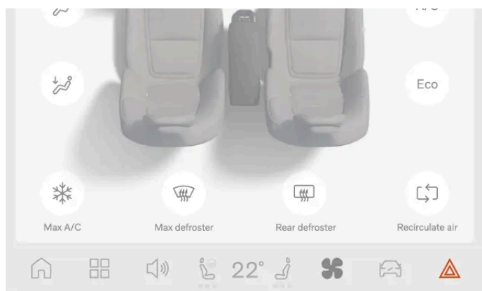
A localização do botão das luzes de emergência no visor
