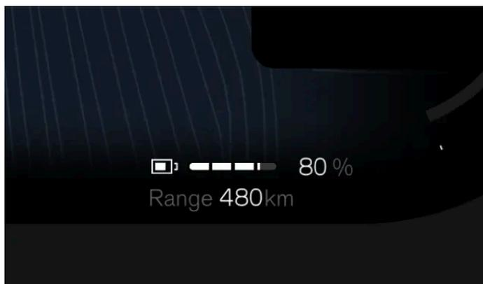
Sua autonomia está relacionada principalmente ao nível da bateria do veículo e às suas práticas de condução, mas as condições externas também podem ser um fator. O nível da bateria e a autonomia esperada são exibidos no visor do motorista. A autonomia esperada é calculada com base em seu padrão de condução, tanto atual quanto histórico.
