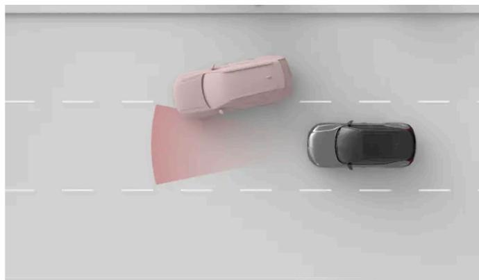
A zona de detecção do radar dianteiro tem uma largura limitada. Se você for ultrapassado por outro veículo, a detecção pode ocorrer relativamente tarde, causando uma resposta repentina do seu veículo.
