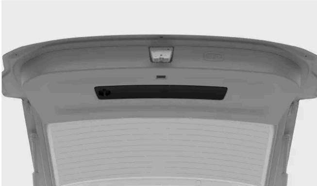
O triângulo de aviso está localizado no interior da tampa do porta-malas. Abra o compartimento girando a alça para que fique na vertical e depois puxando-a.
