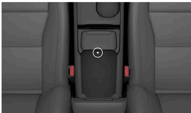
Localização do leitor de reserva dentro do compartimento de armazenamento do console de túnel
