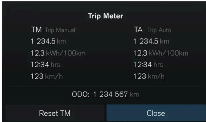
Seu veículo tem um medidor de percurso e um odômetro. O medidor de percurso pode mostrar informações sobre a distância e o tempo de condução do veículo, bem como a velocidade de condução média.
