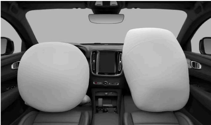
O lado do motorista tem dois airbags dianteiros. O airbag superior é embalado dentro do volante e o airbag de joelho é embalado atrás de um painel abaixo do volante.
