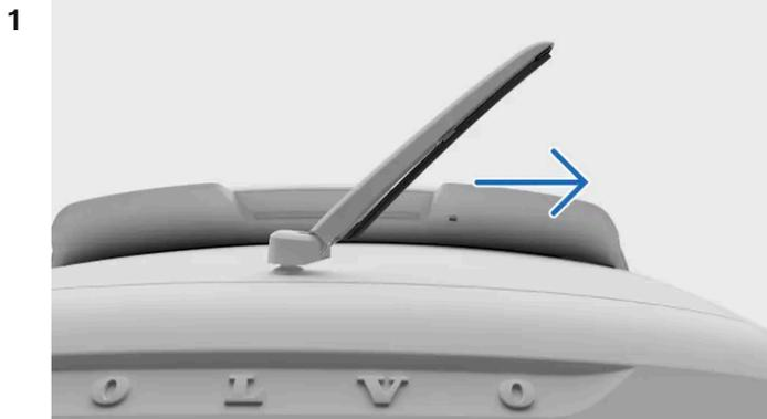
Segure o centro do braço do limpador e levante-o afastando-o do para-brisa traseiro. Você pode sentir alguma resistência no meio do caminho, essa é a posição de travamento. Você precisa puxar o braço do limpador além da posição de travamento para que ele não caia de volta no para-brisa.
