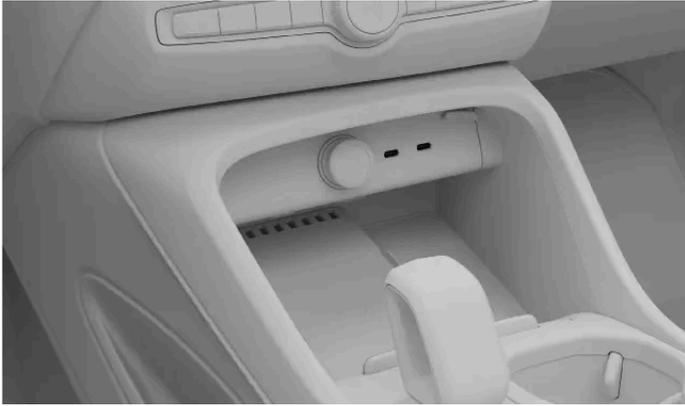
Também há duas portas USB (tipo C) na parte traseira do console de túnel.
