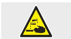
A bateria contém ácido corrosivo.
