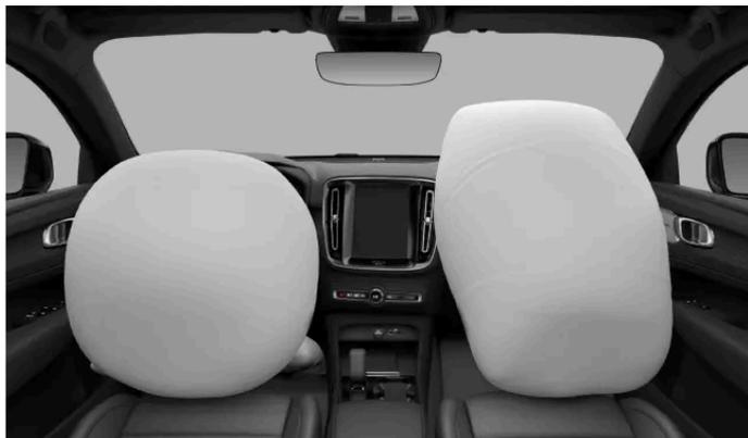
O lado do motorista tem dois airbags dianteiros. O airbag superior é embalado dentro do volante e o airbag de joelho é embalado atrás de um painel abaixo do volante.
