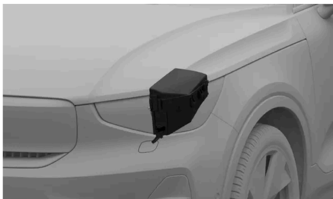
Localização da caixa de fusíveis
