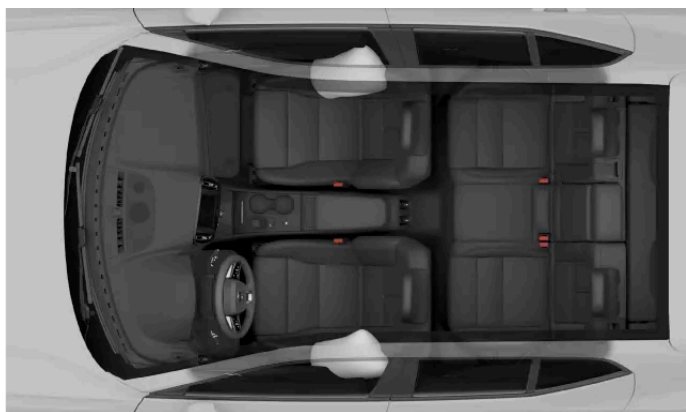
Airbags de colisão lateral dos ocupantes dianteiros.
