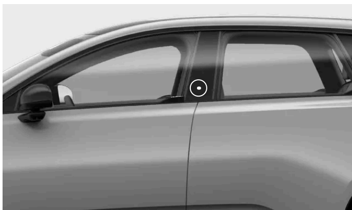
Local de leitura da chave no pilar da porta do motorista
