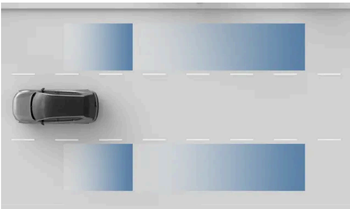
Áreas de detecção de radar.
