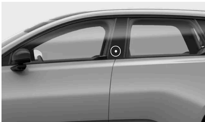
Localização do leitor de chaves no pilar da porta
