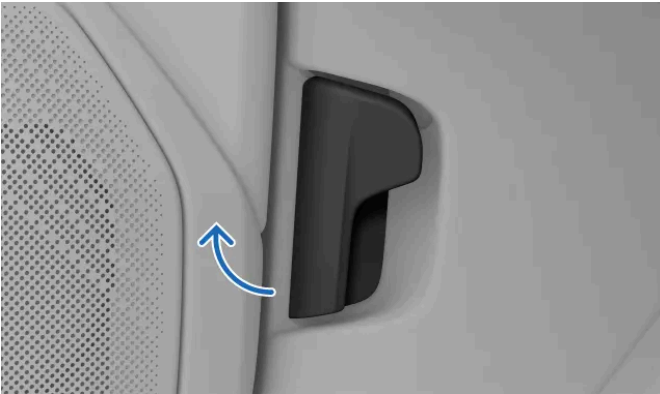
Puxando a alavanca de liberação interna
