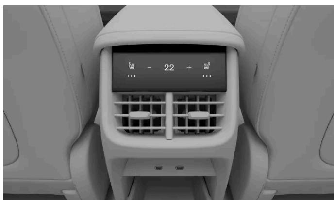
Controles de climatização no console de túnel
