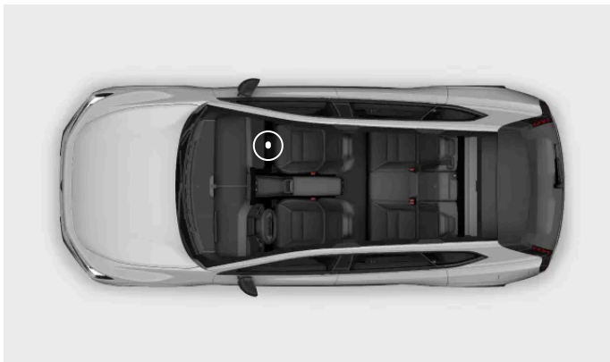
Localização do VIN na viga sob o assento do passageiro
