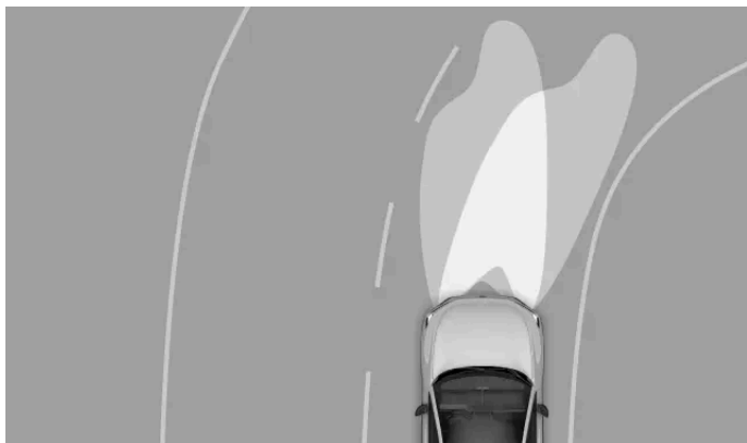
Funcionamento típico das luzes de curva ativas
