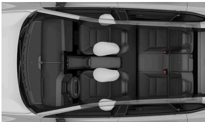
Airbags de colisão de todos os lados dos ocupantes dianteiros.
