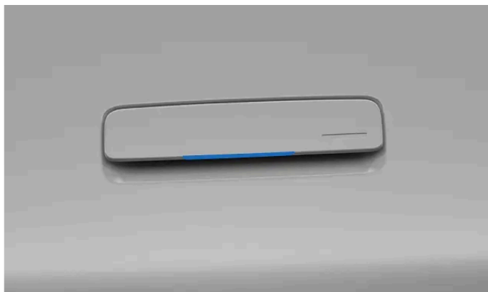
Ponto de toque na parte interna da maçaneta da porta
