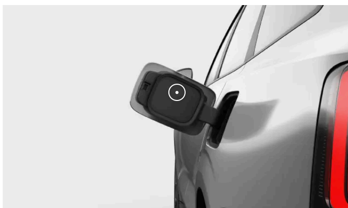
O rótulo de identificação fica na parte interna da tampa de carregamento.
