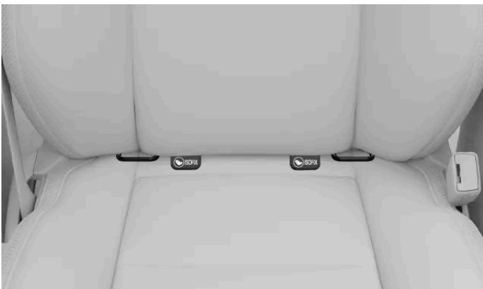
Localização dos pontos de ancoragem ISOFIX do assento do passageiro dianteiro
