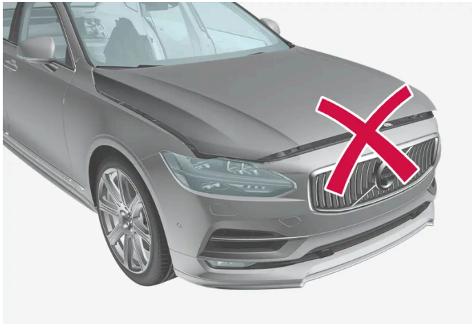
Capô não completamente fechado.
