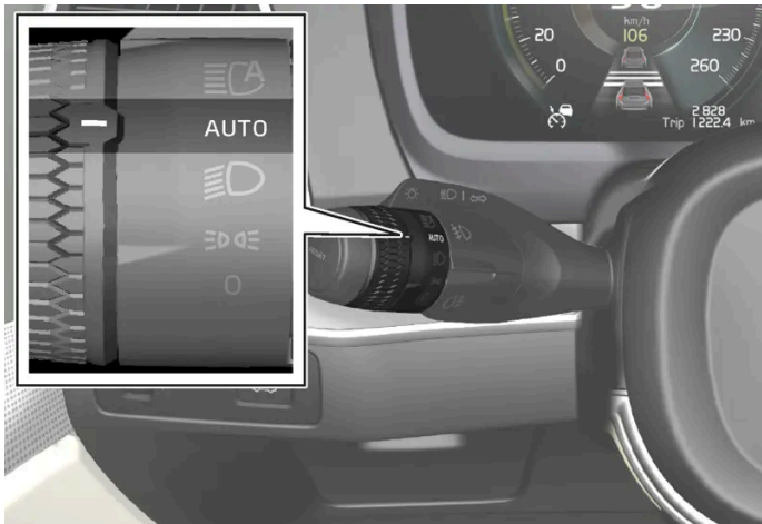
Anel rotativo da alavanca do volante na posição AUTO .
