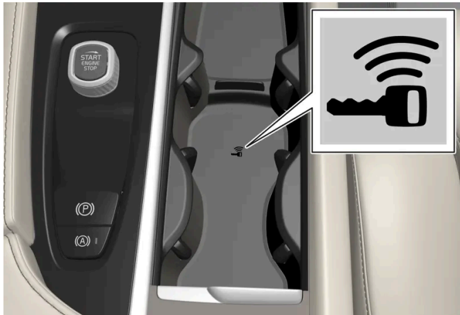
Localização do leitor no console de túnel.
