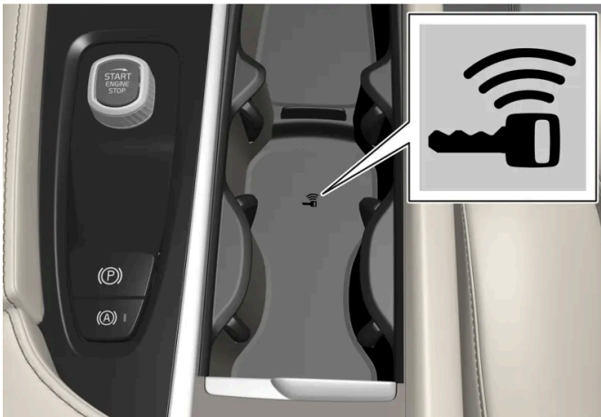
Localização do leitor no console de túnel.
