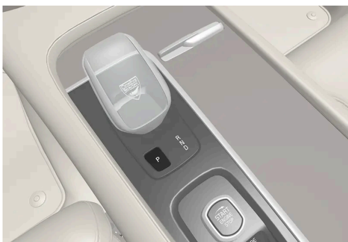
Visão geral da alavanca de marchas e posição P para a alavanca pequena de marchas.
