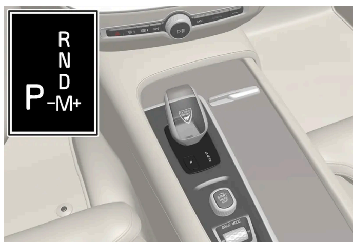
Visão geral da alavanca pequena de marchas e do padrão de mudança de marcha no visor do motorista.
