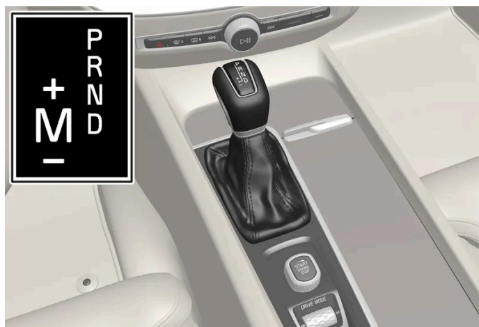
Visão geral da alavanca grande de marchas e do padrão de mudança de marcha no visor do motorista.
