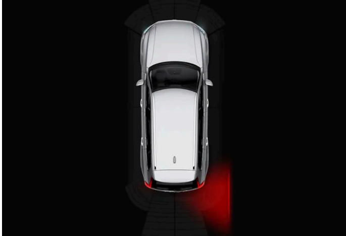
Ícone do Cross Traffic Alert aceso no gráfico Sistema de assistência para estacionamento da tela.
