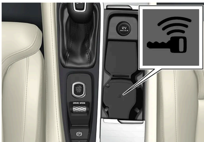
Localização do leitor no console de túnel.
