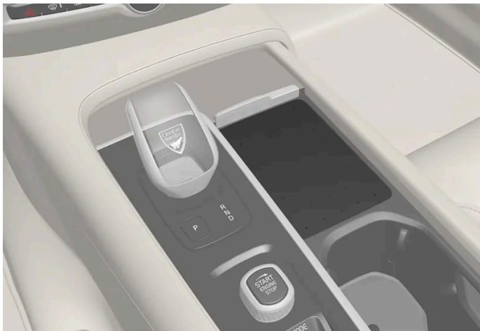
Carregador de telefone sem fio no console do túnel.
