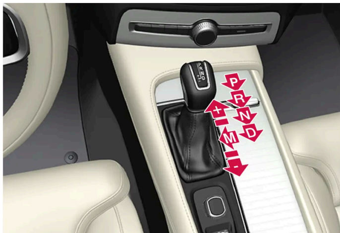
Visão geral da alavanca grande de marchas e posições das marchas.
