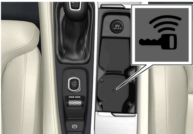
Localização do leitor no console de tûnel.
