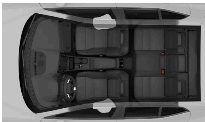
Airbags de colisão lateral dos ocupantes dianteiros.
