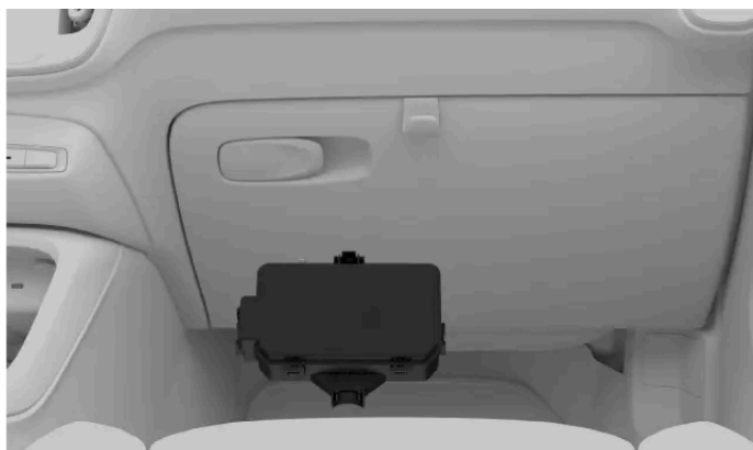
Localização da caixa de fusíveis
