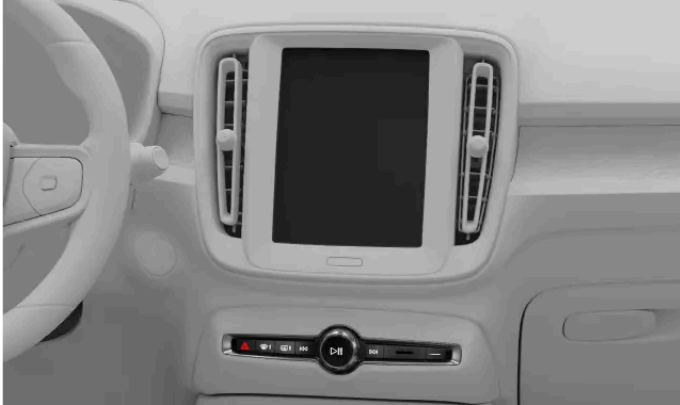
Botões do visor central e de degelo no painel de botão abaixo do visor central
