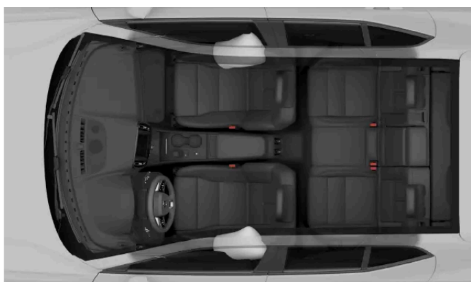
Airbags de colisão lateral dos ocupantes dianteiros.
