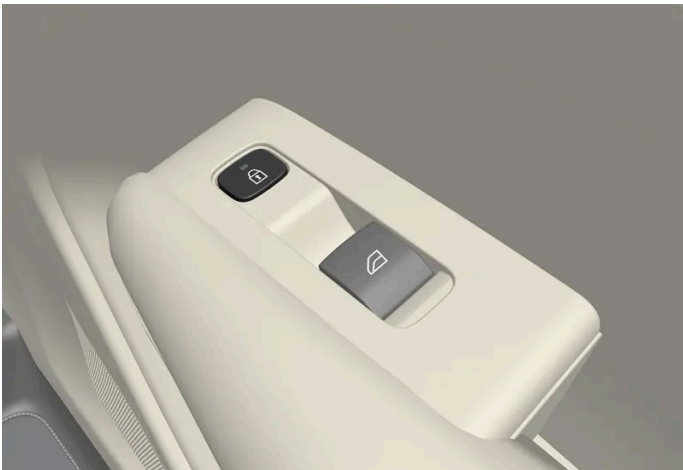
Botão para travamento na porta traseira com luz indicadora.
