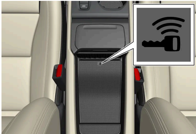
Localização do leitor no compartimento de armazenamento.
