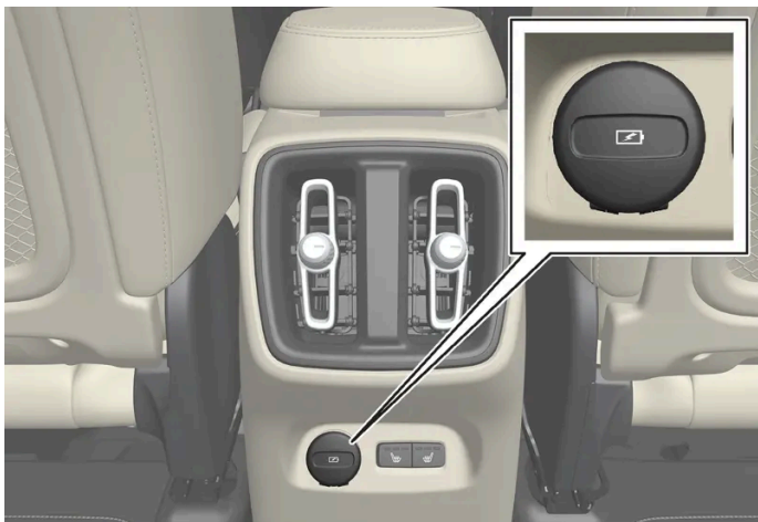
Portas USB* (tipo C) na traseira do console de túnel para carregamento de, por exemplo, telefones ou tablets [1] .
