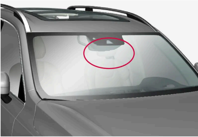
Localização da unidade do radar dianteiro
