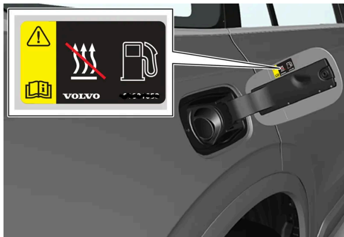
Adesivo de advertência na tampa de abastecimento de combustível.
