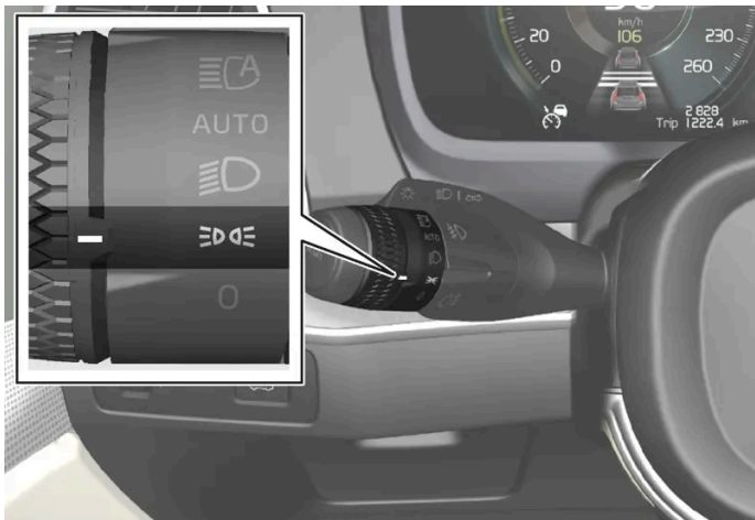
Anel rotativo da alavanca do volante na posição para as luzes de presença.
