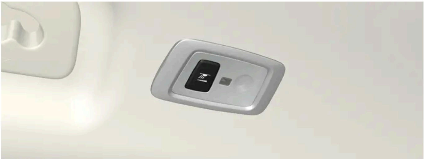
Em veículos com teto panorâmico*, existem duas unidades de lâmpadas, uma em cada lado do teto.
