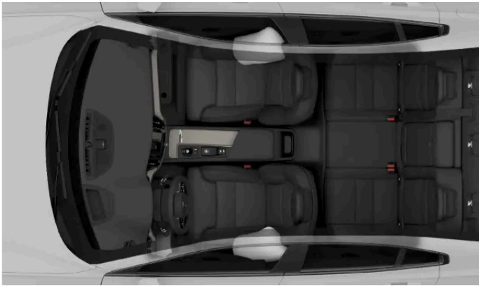
Airbags de colisão lateral dos ocupantes dianteiros.
