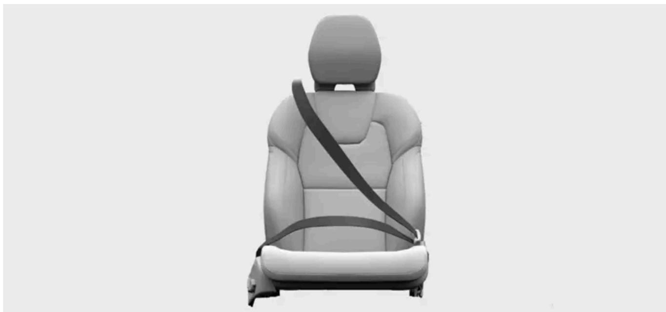
O cinto de segurança trava automaticamente para atuar como uma contenção de segurança sob certas condições, como puxões repentinos e fortes do cinto, se o veículo for conduzido de forma agressiva e se estiver em uma inclinação acentuada.
