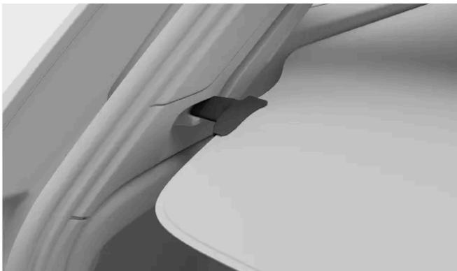
Levante e puxe a extremidade da tela da tampa de carga pela alça para destravá-la. Isso permite a retração da tela de carga.
