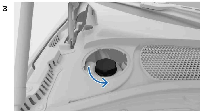
Desparafuse a tampa do recipiente do líquido de arrefecimento.
