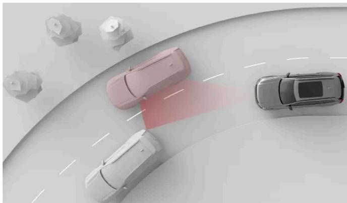
Em uma curva, o veículo adiante pode sair da zona de detecção. Os veículos na faixa adjacente também podem entrar na zona, afetando a percepção do seu veículo quanto à distância do tráfego adiante.
