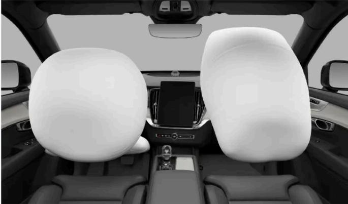
O lado do motorista e o lado do passageiro têm um airbag frontal cada. O airbag do lado do motorista fica localizado dentro do volante de direção e o airbag do lado do passageiro fica localizado atrás de um painel acima do porta-luvas.
