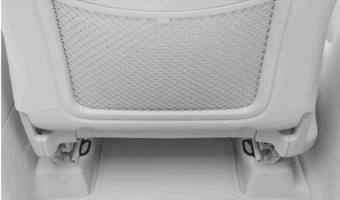
Os pontos de ancoragem do cabo inferior podem ser encontrados na parte de trás dos trilhos do assoalho dos bancos dianteiros.
