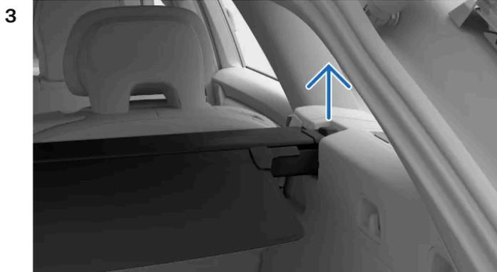
Levante completamente a tampa de carga dos recuos na parte traseira da porta-malas para removê-la.
