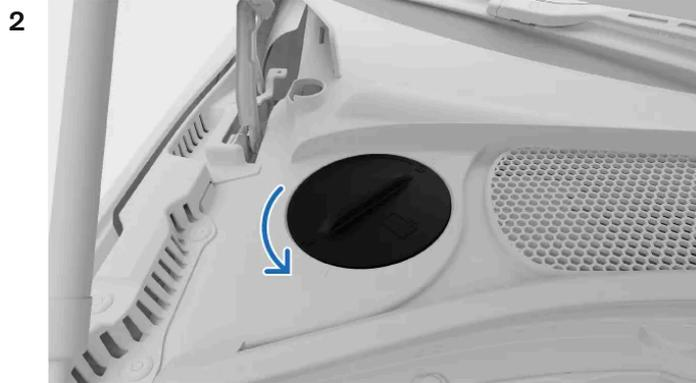
Abra a escotilha do painel no canto superior esquerdo do compartimento do motor para acessar o recipiente do líquido de arrefecimento.
