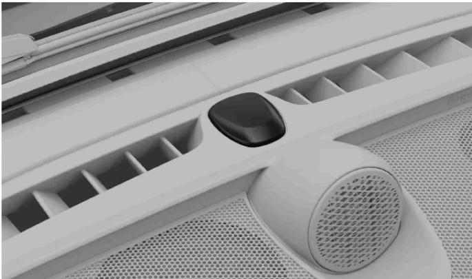
O indicador de alarme é uma luz localizada no centro do painel, bem em frente ao para-brisa. O indicador confirma quando o alarme é ativado com uma luz vermelha piscante.
