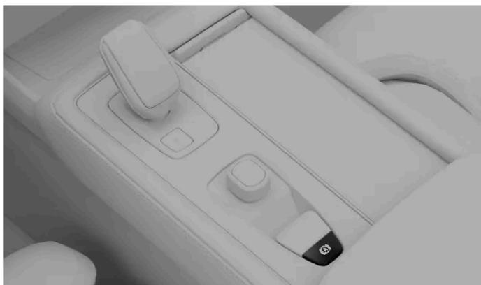
1 Pressione o botão de retenção automática no console de túnel.
