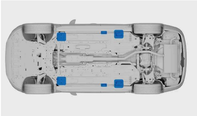
Existem dois pontos de levantamento em cada lado do veículo.
