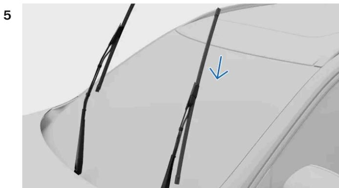
Certifique-se de que a palheta do lado do motorista seja mais longa que a palheta do lado do passageiro. Deslize a palheta do limpador para o braço do limpador. Certifique-se de que o pino no braço do limpador entre no orifício na palheta do limpador. Empurre a palheta no braço do limpador até ouvir um clique.
