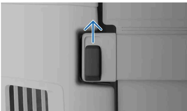
Há botões de travamento nas extremidades da tampa de carga. Empurre o botão lateral para a frente e mantenha-o no lugar enquanto levanta a extremidade da tampa de carga. Faça o mesmo na outra extremidade da tampa de carga.
