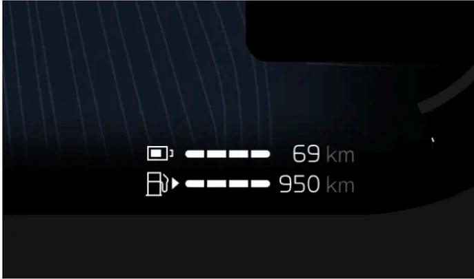
Sua autonomia está relacionada principalmente à bateria do veículo, à quantidade de combustível restante no tanque do veículo e às suas práticas de condução, mas as condições externas também podem ser um fator. O nível da bateria e a autonomia esperada são exibidos no visor do motorista. A autonomia esperada é calculada com base em seu padrão de condução, tanto atual quanto histórico.
