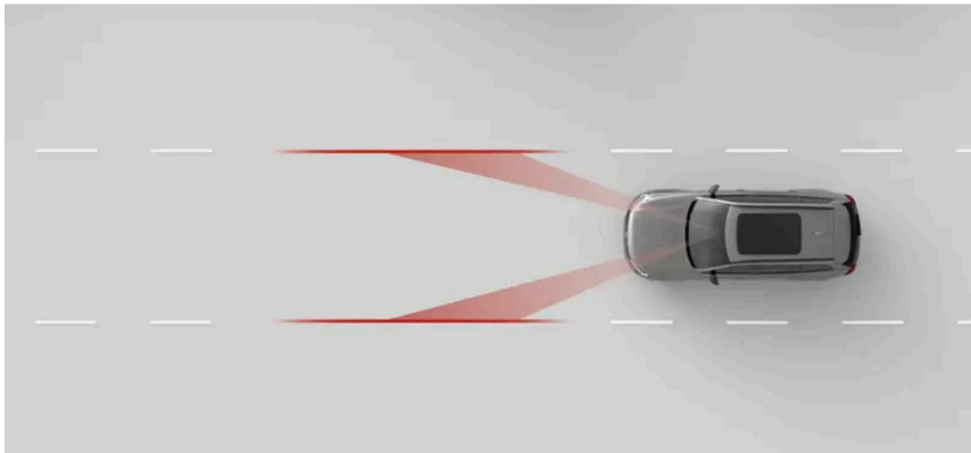
Quando a assistência de permanência de faixa está ativada, o veículo pode alertar se estiver prestes a sair da faixa e pode solicitar que você dirija o veículo com atenção. Ele também pode realizar intervenções na direção. O auxílio de permanência na faixa depende da câmera dianteira do veículo para identificar as marcações da pista e sua posição na faixa.
