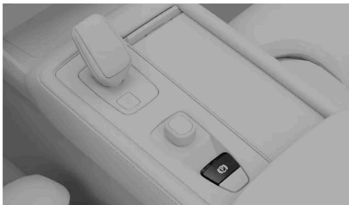
Acione manualmente o freio de estacionamento puxando o interruptor do freio de estacionamento.
