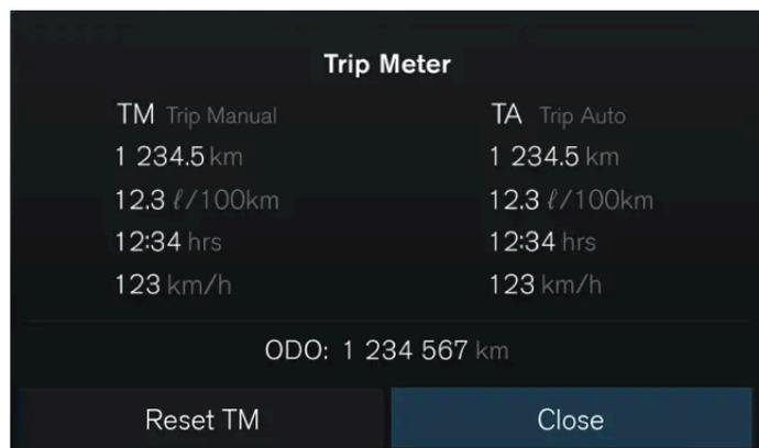
Seu veículo tem um medidor de percurso e um odômetro. O medidor de percurso pode mostrar informações sobre a distância e o tempo de condução do veículo, bem como o consumo de combustível médio e a velocidade de condução.
