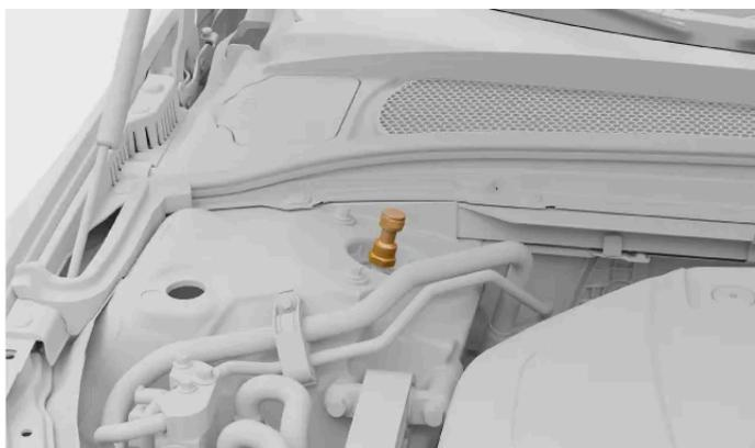
Os botões de ajuste da suspensão das rodas dianteiras ficam localizados sob o capô.
