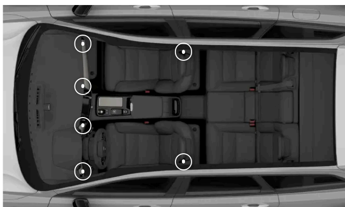
As posições das ventilações ajustáveis
