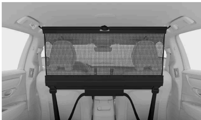
Instalação atrás dos assentos da segunda fila
